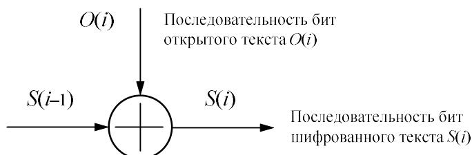
Рисунок 1 — Схема преобразования закодированного сообщения.
