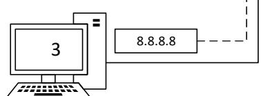
IP и MAC-адрес источника, записанные в заголовке пакета, отправленного с компьютера № 3 на адрес 8.8.8.8, при его приходе на маршрутизатор: IP — 192.168.1.2, MAC — D805E65239B1.
